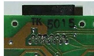
Beim internen 1050-PC Interface wird hier das fünfadrige Flachbandkabel der Reihe nach an die SIO-Pins angelötet (Leitung Pin 3 ist rot markiert). Bei der externen Variante entspricht Pin3 – gelb, Pin4 – schwarz, Pin5 – grün, Pin7 – violett und Pin10 – blau.
